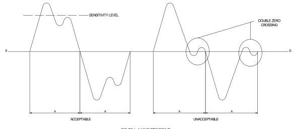
FIGURE 1 - 2. MAGNETIC PICKUP OUTPUT WAVEFORMS
